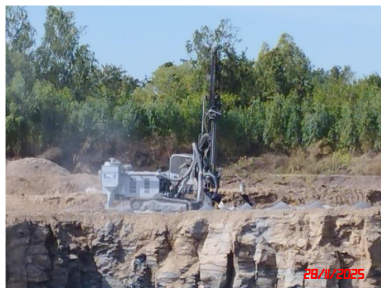
รูปที่ 7 รถเจาะรูระเบิดที่มีอุปกรณ์เก็บฝุ่นติดไว้กับหัวเจาะ
